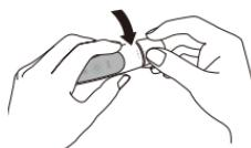
本体の中心部と下部を図のように持ち、本体下部を矢印の方向にひねって電池カバーを開きます。
